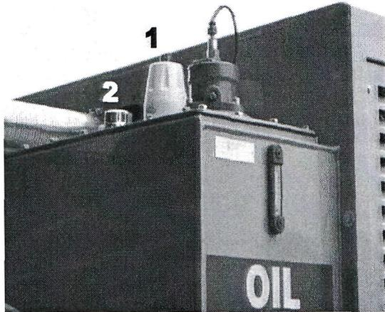
Figura n° 76 Filtro aria (1) e tappo di carico (2)
