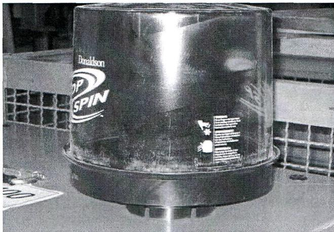
Figura n° 25 Prefiltro aspirazione aria motore
