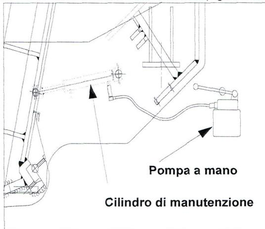
Figura n° 88 Cilindro di manutenzione
