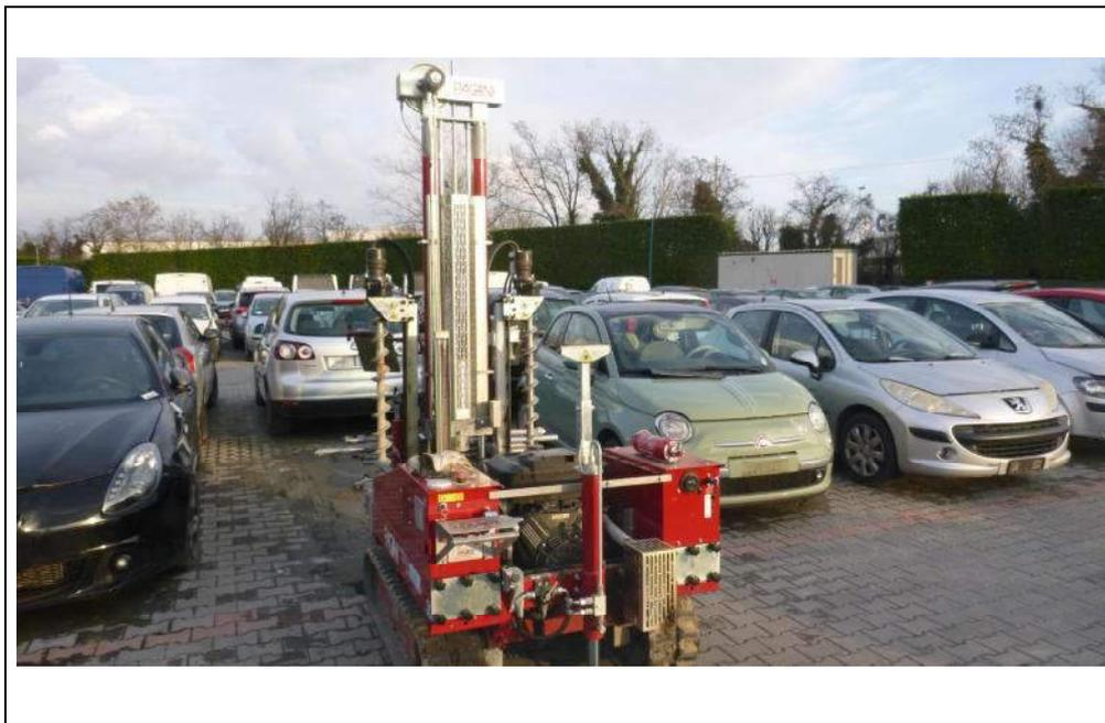
Foto 4: Esecuzione prova DPSH4
