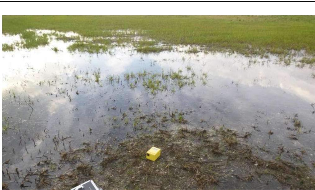
Foto 9: Indagine sismica passiva HVSR
