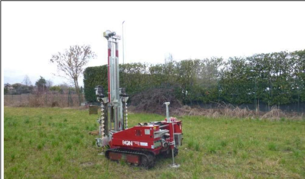
Foto 6: Esecuzione della prova DPSH6
