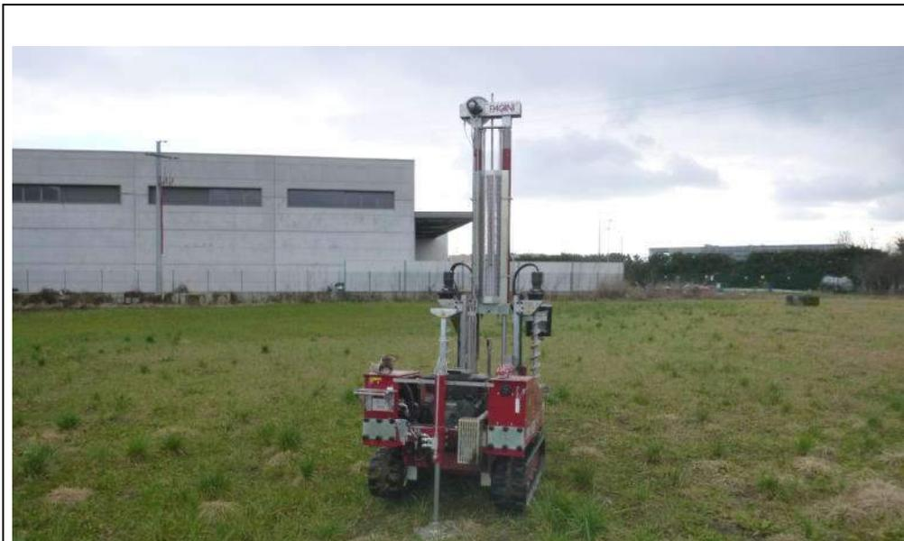
Foto 7: Esecuzione prova DPSH7
