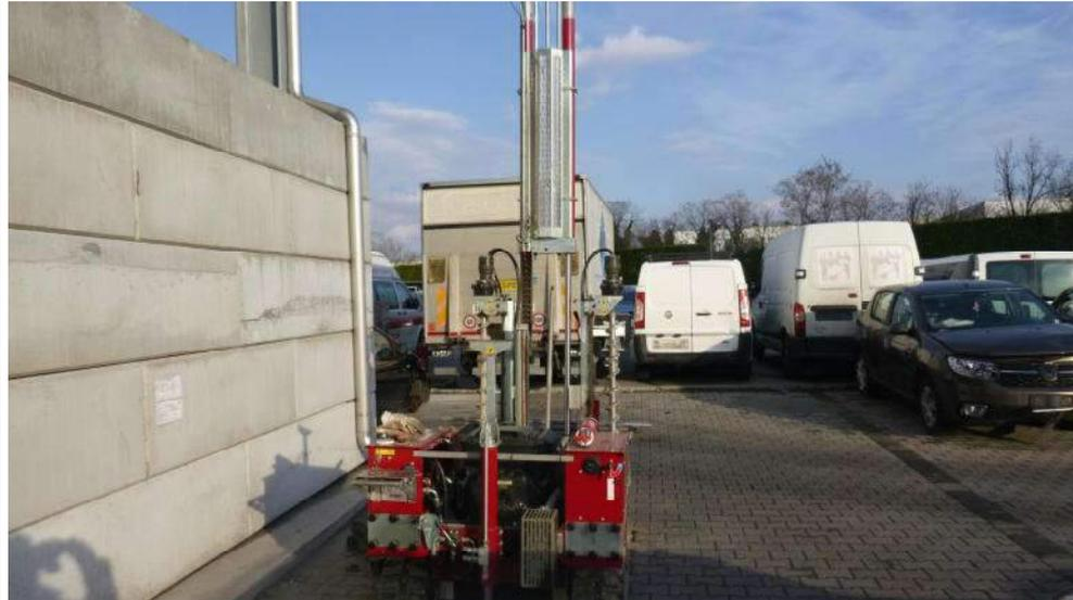
Foto 2: Esecuzione prova DPSH2
