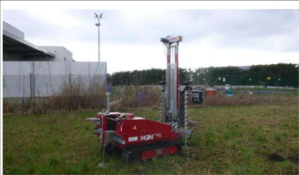
Foto 8: Esecuzione della prova DPSH8
