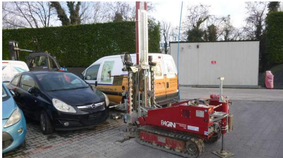
Foto 3: Esecuzione prova DPSH3
