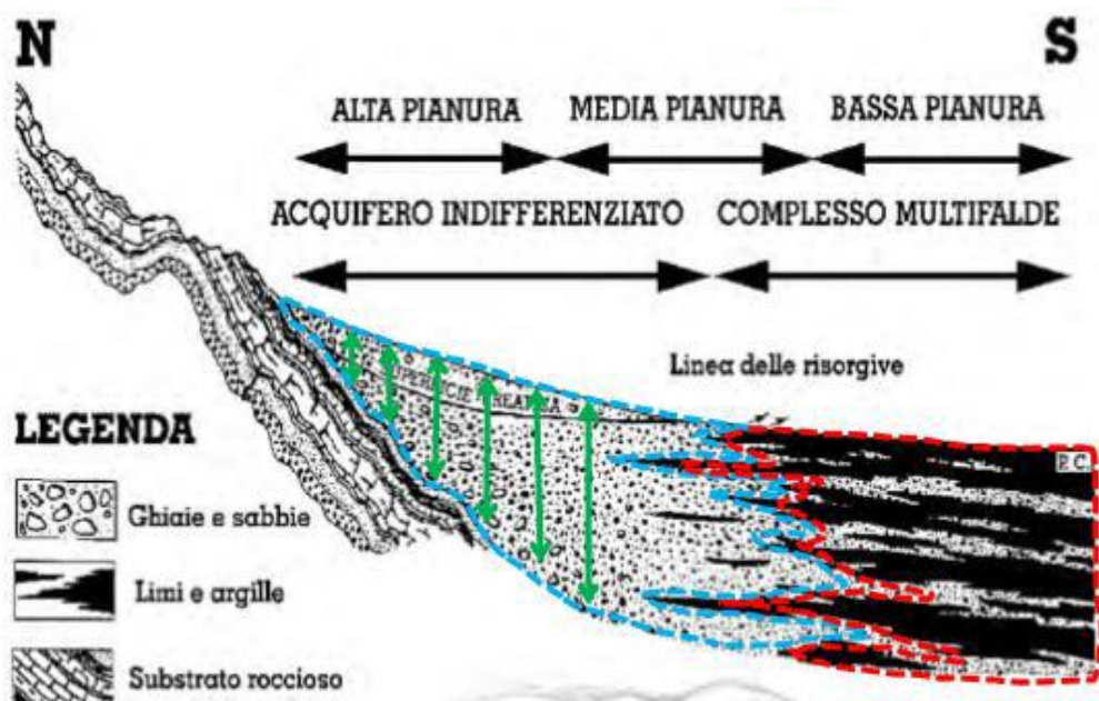
Figura 82: Schema idrogeologico bassa pianura.
