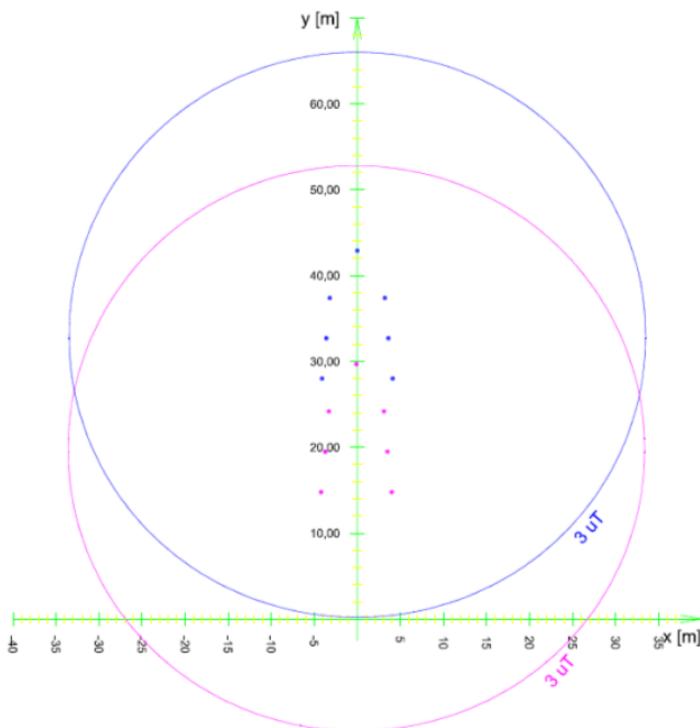
Figura 54: Sezione dei cavi dell'elettrodotto: In blu la sezione e la fascia di rispetto presso il traliccio, in magenta la sezione 130 m a sud del traliccio (dati di Terna Rete Italia spa).
