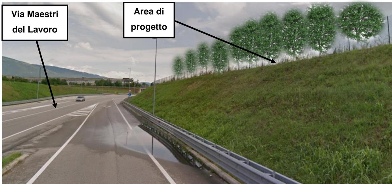
Figura 49: Fotomontaggio del filare alberato previsto come elemento di mitigazione, al confine con via Maestri del Lavoro.
