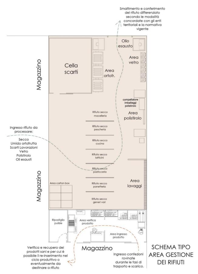
Figura 2-5. Schema tipo area di gestione rifiuti
