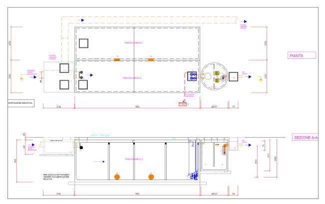
Figura 2-4. Pianta e sezione impianto di prima pioggia
