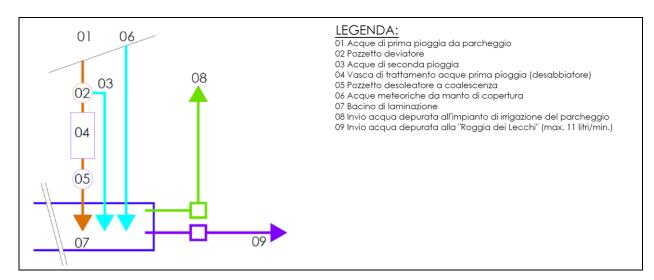
Figura 2-2. Schema gestione acque meteoriche provenienti dalla nuova area di parcheggio
