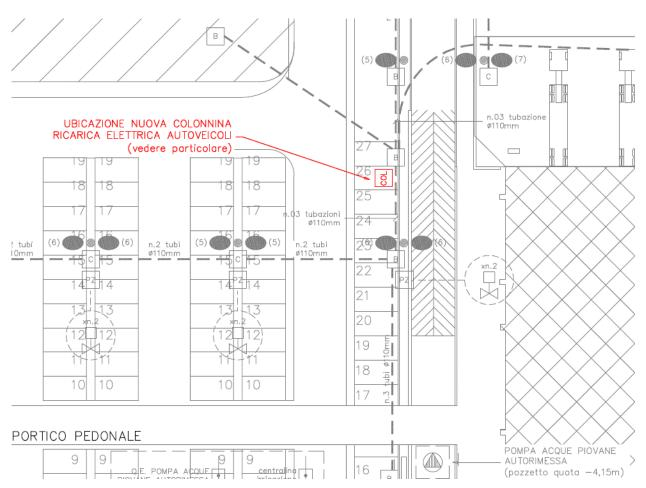
Figura 2-9. Localizzazione del posizionamento della colonnina di ricarica elettrica autoveicoli
