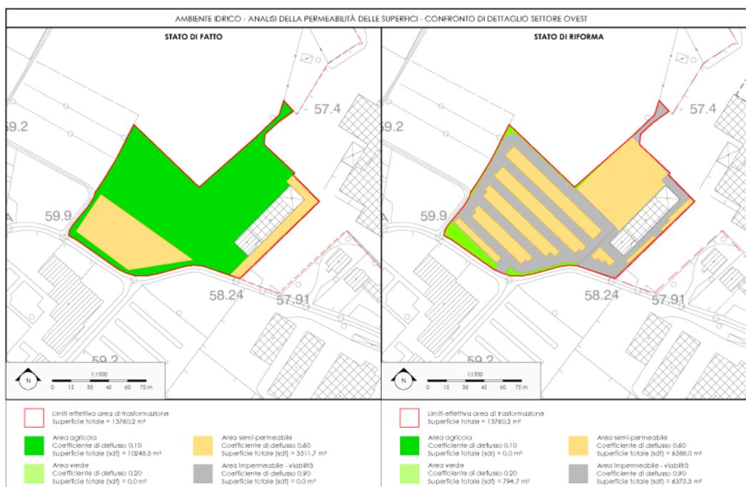
Figura 8: analisi della permeabilità delle superfici – confronto settore ovest
