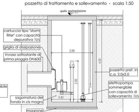
SEZIONE B-B pozzetto di trattamento e sollevamento - scala 1:50
