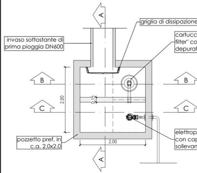
SEZIONE A-A pozzetto di trattamento e sollevamento - scala 1:50
