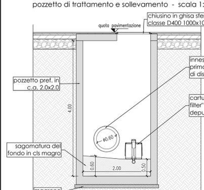
SEZIONE C-C pozzetto di trattamento e sollevamento - scala 1:50
