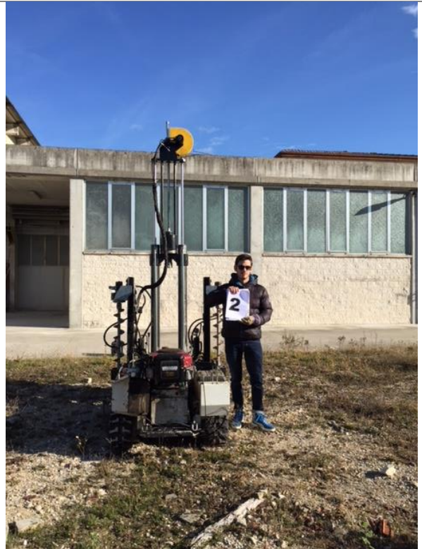
Vista del punto di esecuzione della prova penetrometrica dinamica DIN2
