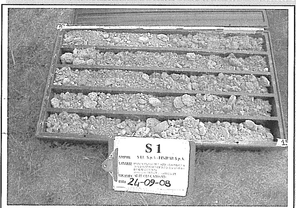
Sondaggio a rotazione a carotaggio continuo S1 tratto da 10 m a – 15 m
