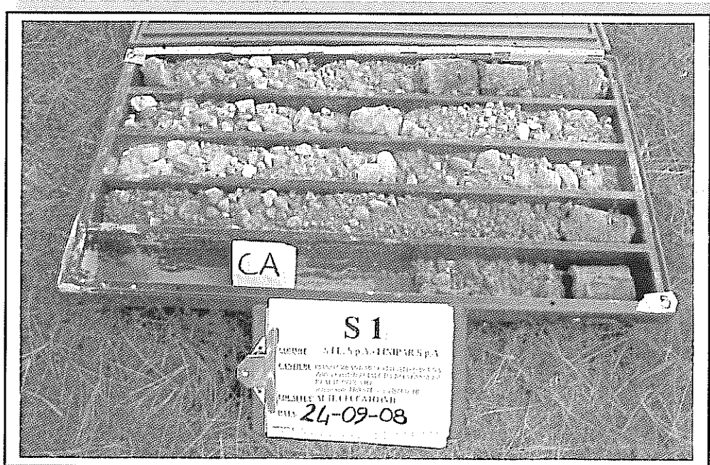
Sondaggio a rotazione a carotaggio continuo S1 tratto da 0 m a – 5 m
