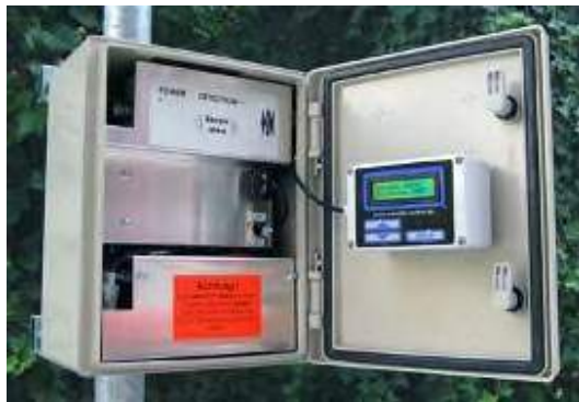
Figura 2.1 – Strumentazione radar Wavetech
