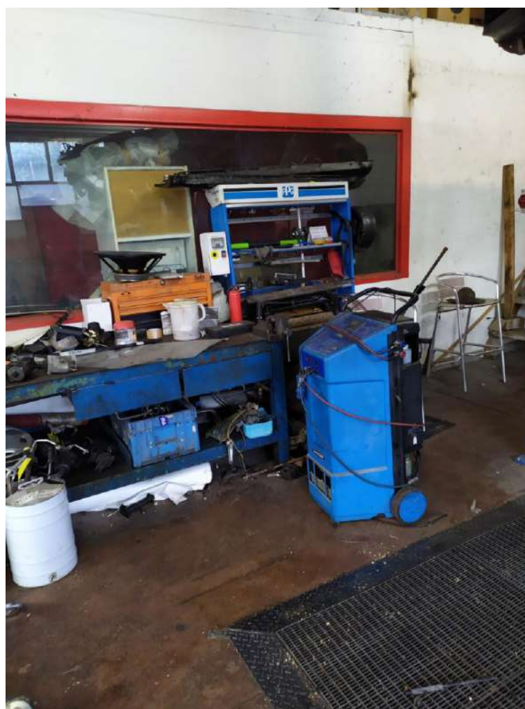
15) Macchina estrazione freon, griglia per la raccolta sotto i ponti di messa in sicurezza e banco lavoro
