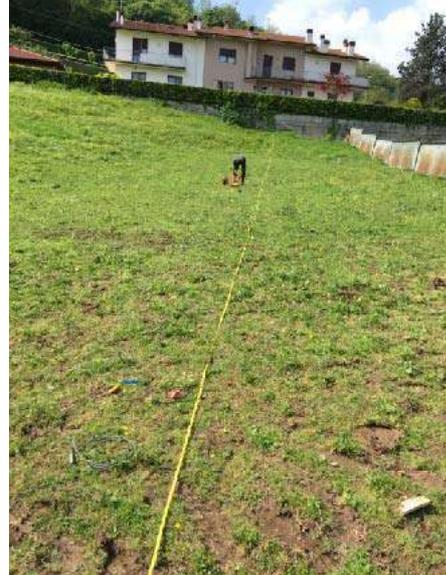
*Esecuzione stendimenti sismici a rifrazione*
