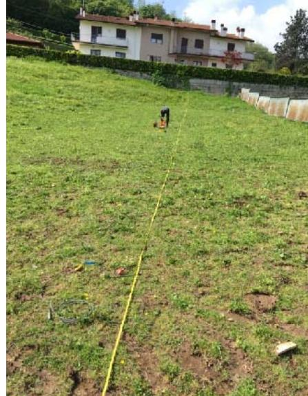
*Esecuzione stendimenti sismici a rifrazione*
