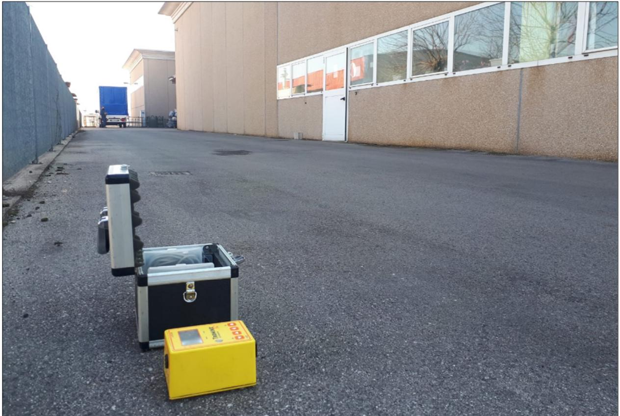
Figura 9 - Tromografo in fase di acquisizione
