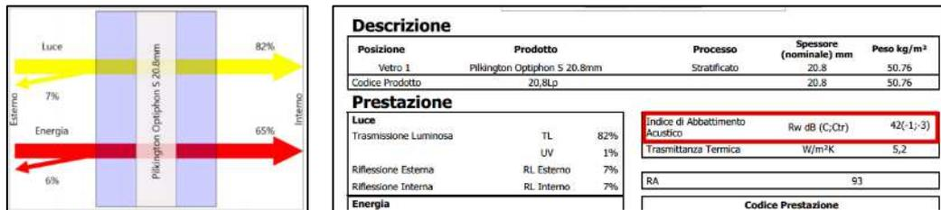
FIGURA 5-2 - ESTRATTO SCHEDA TECNICA DELLA POSSIBILE BARRIERA ACUSTICA
