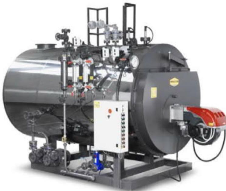
I generatori sono del tipo a tubi di fumo prodotti dalla Ditta Mingazzini mod. PVR-20 con portata termica unitaria pari a 1550 kW e producibilità nominale di 2.000 kg/h di vapore saturo alla pressione nominale di 14,7 Bar.
