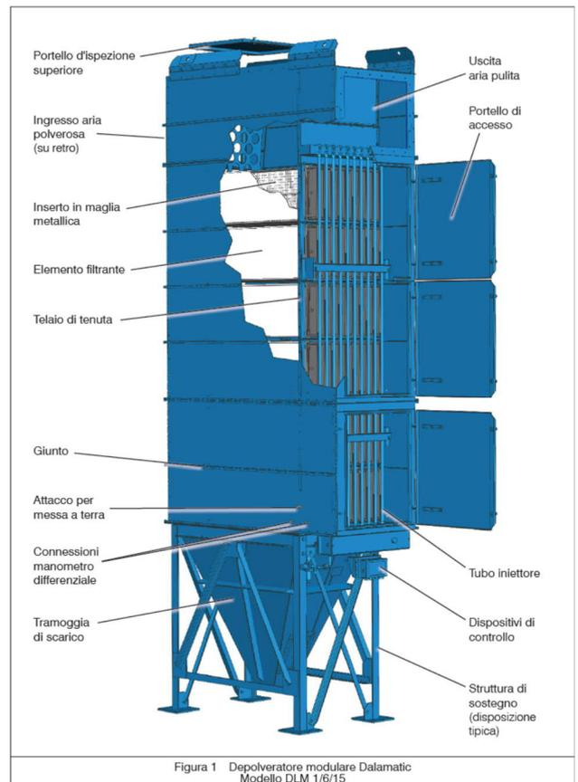
Figura 1 Depolveratore modulare Dalamatic Modello DLM 1/6/15
