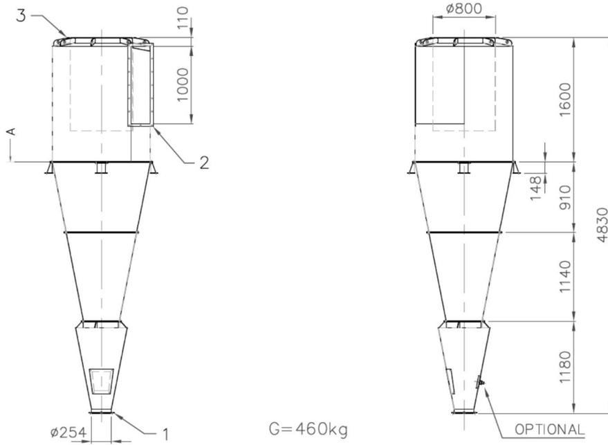
Figura 9: sezione ciclone abbattitore
