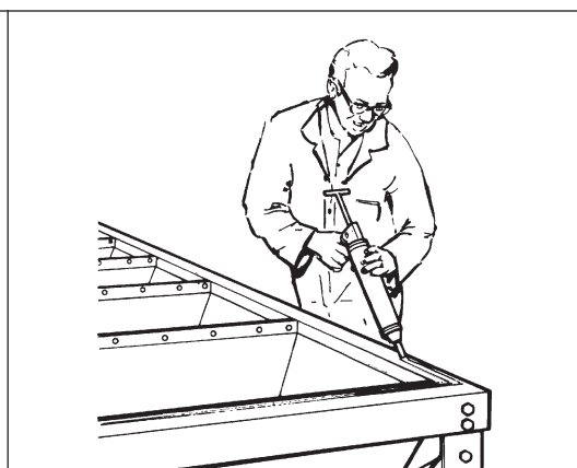
Figura 10 Applicare il sigillante alla flangia della tramoggia
