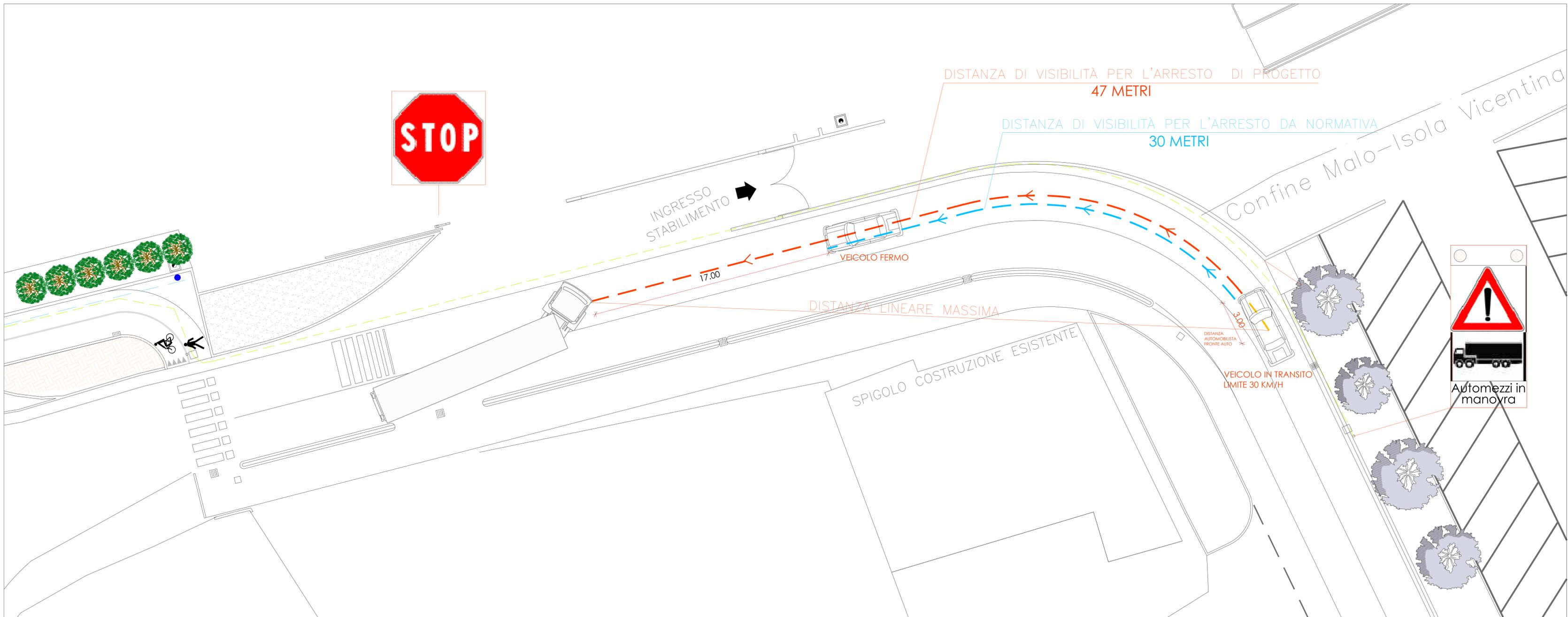
LO SPAZIO DI FRENATA PER IL VEICOLO CHE SOPRAGGIUNGE ALLA VELOCITÀ DI 30 KM/H (LIMITE MASSIMO CONSENTITO), DAL COMUNE DI ISOLA VICENTINA VERSO IL COMUNE DI MALO, PERCORRENDO VIA S. TOMIO, È DI CIRCA **30 METRI LINEARI**. TALE DISTANZA VIENE ESTRAPOLATA DALLA NORMATIVA IN MATERIA DI PROGETTAZIONE E COSTRUZIONE FUNZIONALE DI STRADE (D.M. N° 6792 DEL 05/11/2001 E SUCCESSIVE REVISIONI).
