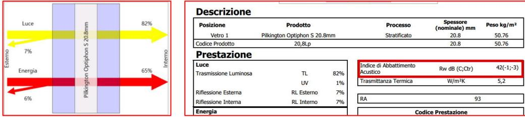
FIGURA 4-29 - ESTRATTO SCHEDA TECNICA DELLA POSSIBILE BARRIERA AUSTICA
