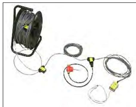
sismografo tramite un'interfaccia USB. Tale sistema permette di avere elevati rapporti di rumore, un perfetto sincronismo e una estrema leggerezza. La spaziatura utilizzata tra i geofoni è stata di 2 m quindi la lunghezza complessiva del profilo è risultata essere di 30 m. Non sono presenti sostanziali variazioni di quota e quindi il sito può essere considerato orizzontale.
