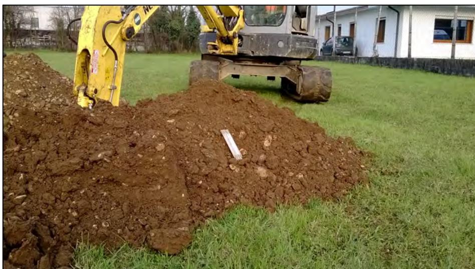
*Ammasso cumuliforme da cui si è prelevato il campione*
