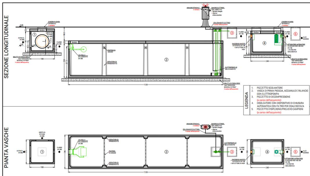
FIGURA 4-22. SEZIONE LONGITUDINALE E PIANTE DELL'IMPIANTO DI PRIMA PIOGGIA CON DISOLEATORE ESTERNO
