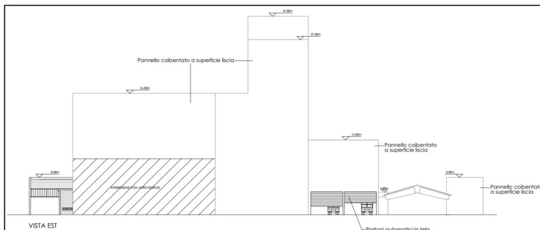
FIGURA 4-3. VISTA EST DELL'INTERVENTO CON VISUALIZZATE LE VARIE QUOTE DELL'EDIFICIO PRODUTTIVO (A E B)
