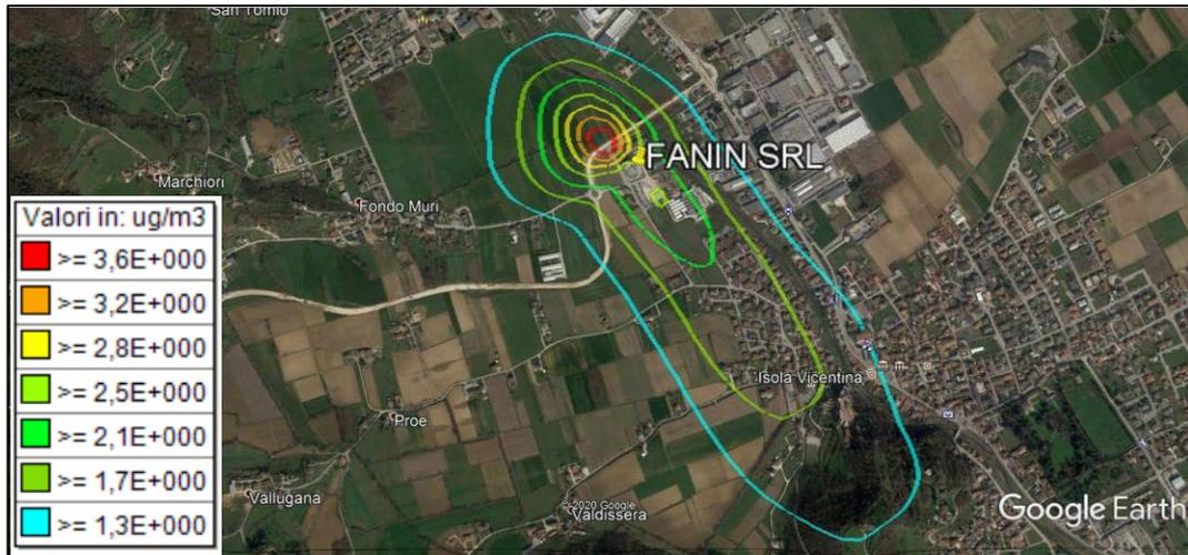
FIGURA 5-20. RAPPRESENTAZIONE GRAFICA DEL VALORE MEDIO TOTALE DI CONCENTRAZIONE DELLE POLVERI (µG/MC)
