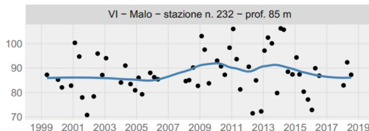
FIGURA 5-22. DIAGRAMMA PIEZOMETRICO DELLA STAZIONE DI MALO. I PUNTI INDICANO LE MISURAZIONI, LA LINEA LA REGRESSIONE LOCALE DI TIPO LOESS CON PARAMETRO DI LISCIAMENTO 1/2 (ARPAV, 2019)
