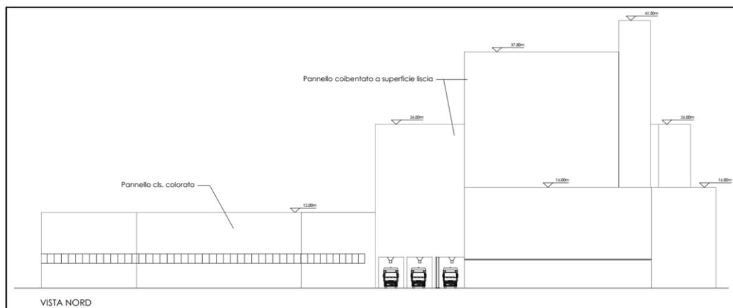
FIGURA 4-2. VISTA NORD DELL'INTERVENTO CON VISUALIZZATE LE VARIE QUOTE DELL'EDIFICIO PRODUTTIVO (A E B)
