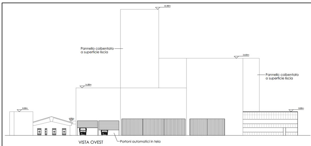
FIGURA 4-5. VISTA OVEST DELL'INTERVENTO CON VISUALIZZATE LE VARIE QUOTE DELL'EDIFICIO PRODUTTIVO (A E B)
