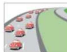
livello F: è la zona di flusso forzato e di congestione. Si verifica quando il flusso di traffico in una sezione ne eccede la capacità, causando la formazione della coda: la densità, peraltro, aumenta fisso a raggiungere il massimo. Questo livello viene utilizzato per identificare le condizioni di coda o congestione (marcia a singhiozzo o "stop and go").
