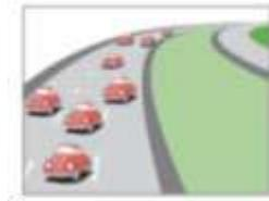
livello E: rappresenta la capacità del sistema. Il flusso è instabile e non c'è quasi possibilità di scelta di velocità e di manovra. La velocità operativa è soggetta a rapide fluttuazioni. il comfort è basso e il potenziale di incidentalità è alto. Piccoli aumenti di traffico possono causare la congestione. Le condizioni di deflusso sono al limite della instabilità.
