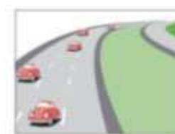
livello C: è una zona di flusso stabile dove, però sono significativamente ristrette le libertà di scelta di velocità, cambio corsia o sorpasso. La velocità operativa è compresa nell’intervallo compreso tra i 2/3 e 3/4 della massima velocità
