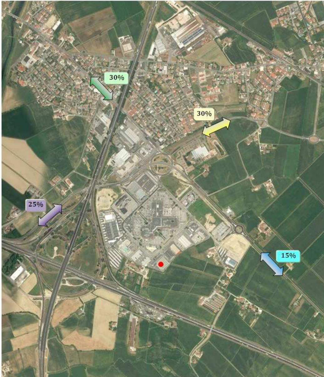
Figura 15. Schema di ripartizione del traffico indotto sulla viabilità esterna.
