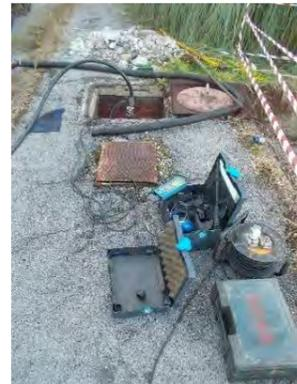
Esecuzione prova di tenuta della cisterna
