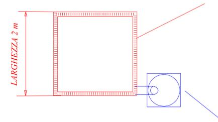
Pozzetto a tenuta da 80 x 80 con fusto da 30 litri di raccolta spanti posto all'interno
