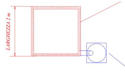
Pozzetto a tenuta da 80 x 80 con fusto da 30 litri di raccolta spanti posto all'interno
