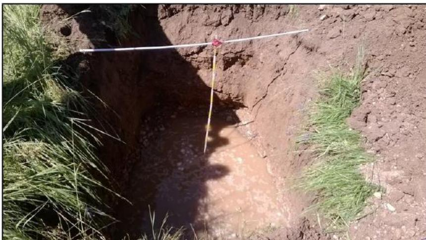
Foto 2 – Esecuzione prova di permeabilità sul fondo di una trincea esplorativa.
