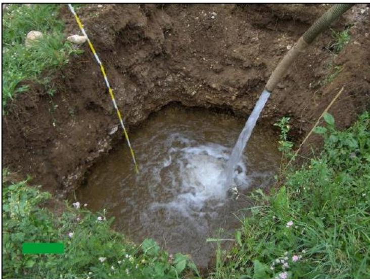
Foto 1 – Esecuzione prova di permeabilità sul fondo di una trincea esplorativa.
