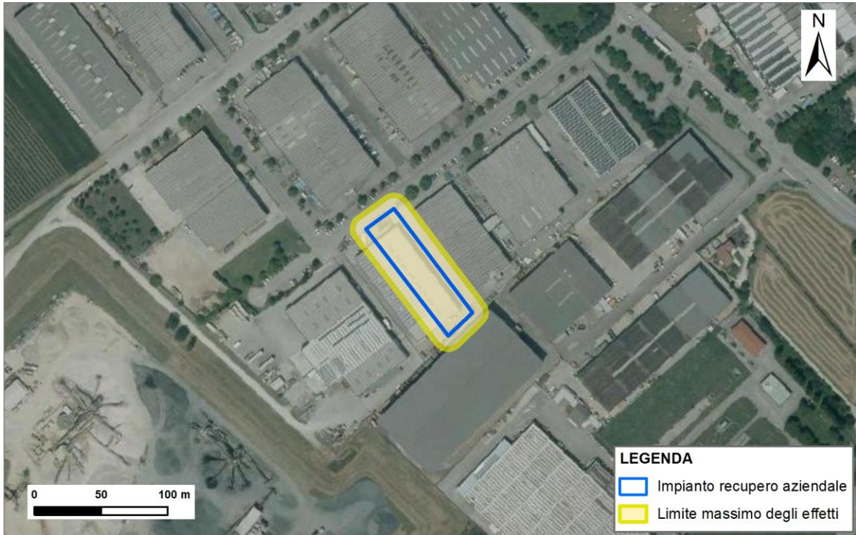
FIGURA 7. RAPPRESENTAZIONE DEL LIMITE MASSIMO DEGLI EFFETTI (RUMOROSITÀ AMBIENTALE PRODOTTA DALL'IMPIANTO > 50 DB).
