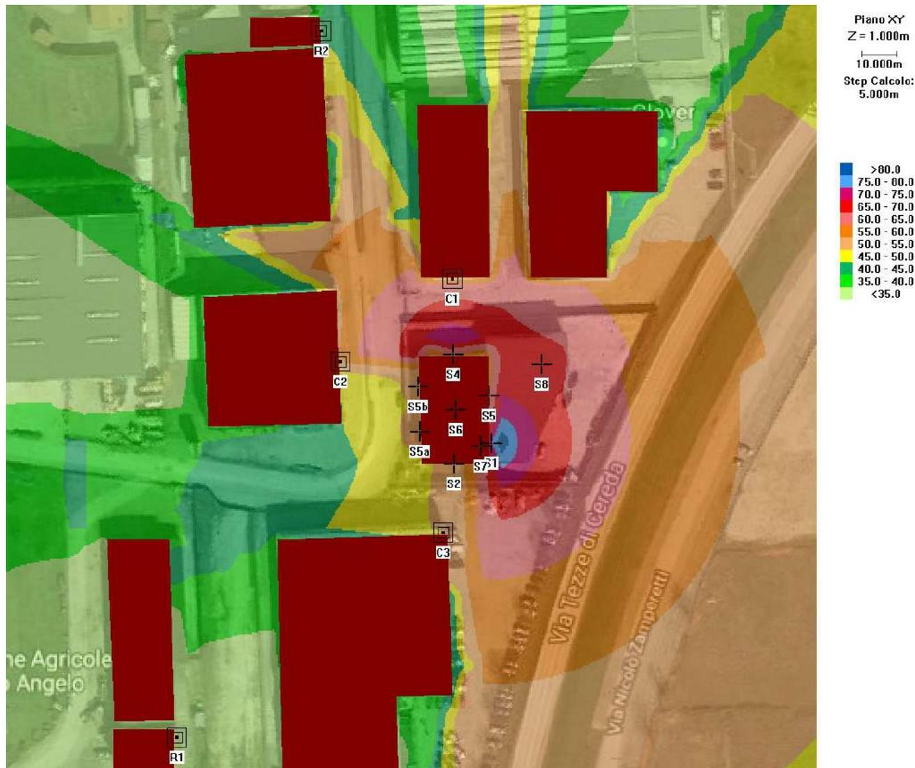
Cautelativamente nel modello di propagazione, i portoni siti a Nord e ad Est sono stati considerati mantenuti aperti e la bocca di carico che comunicherà con l'esterno del capannone, ma sarà coibentata con pannelli fonoisolanti, è stata considerata all'esterno completamente senza nessuna mitigazione, con conseguente sovrastima della potenza acustica dell'impianto di triturazione verso l'esterno.
