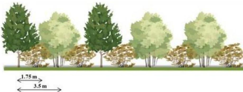
FIGURA 8. RAPPRESENTAZIONE SCHEMATICA DELLA SIEPE MISTA DI PROGETTO.
