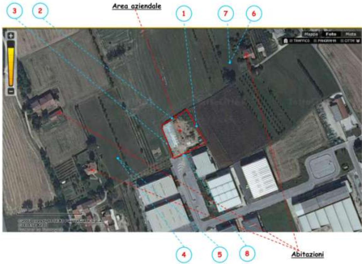
FIGURA 36. INDAGINE ACUSTICA: POSIZIONI DI MISURA.
