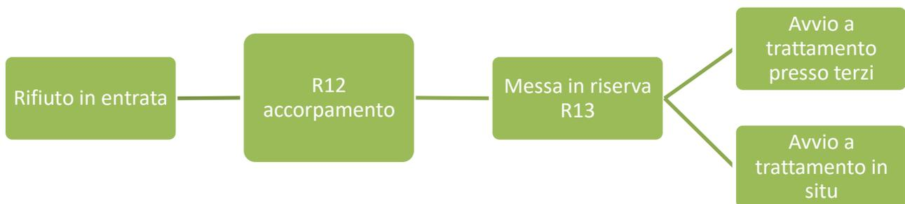
**Figura 8 - Schema gestione rifiuti sottoposti all'operazione di scambio di rifiuti R12 ACCORPAMENTO.**
