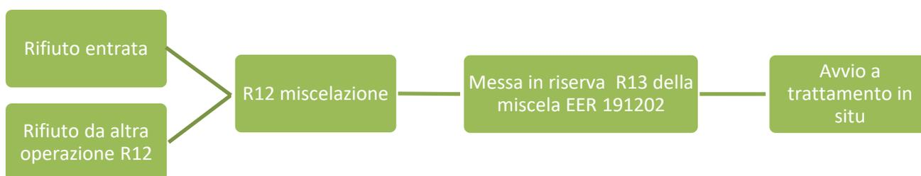
**Figura 15 - Schema gestione rifiuti sottoposti all'operazione di scambio di rifiuti R12 MISCELAZIONE.**
