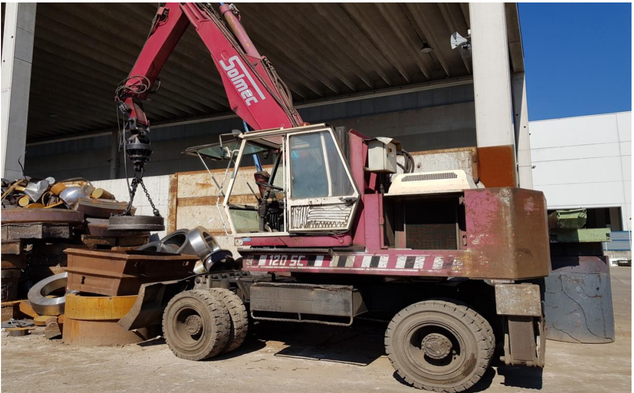
Figura 19 – Fotografia del SOLMEC 120 SC con agganciato il magnete al posto del polipo.
