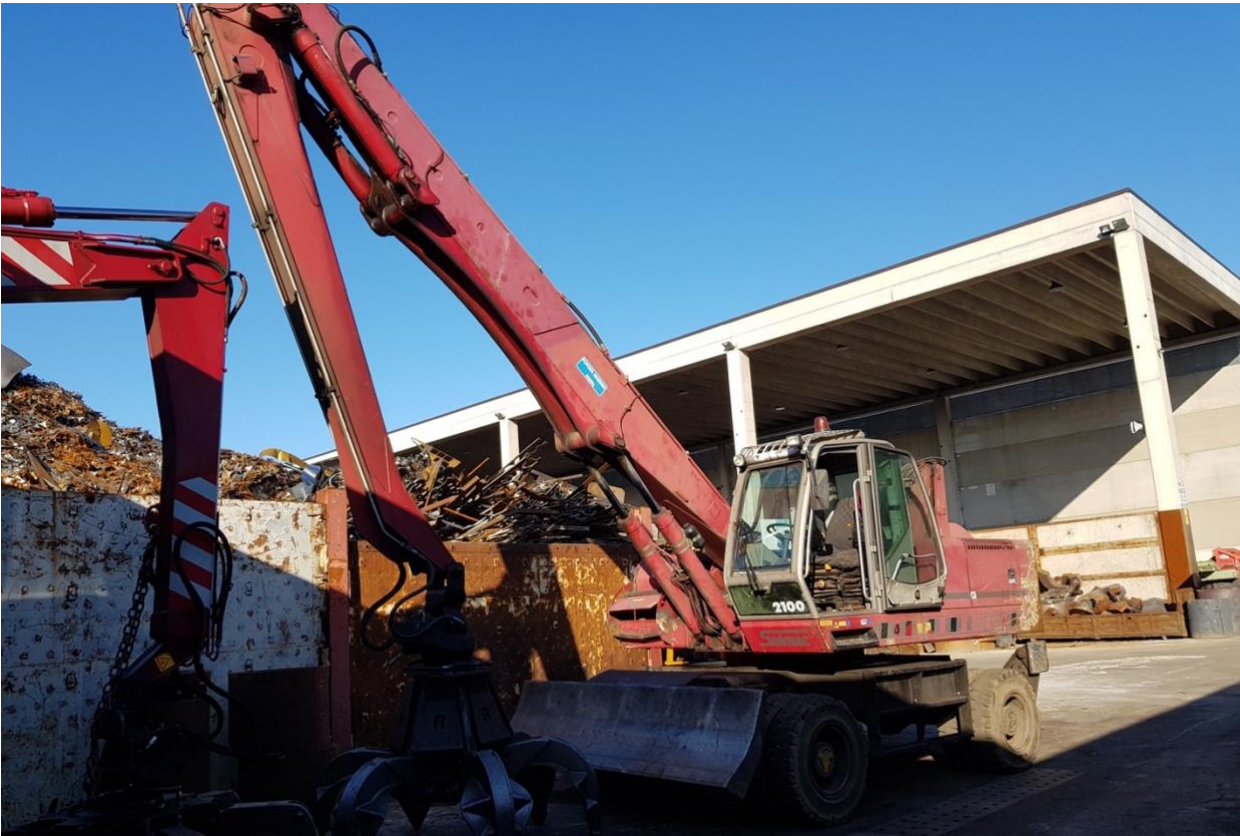
Figura 21 – Fotografia del SOLMEC 412 ESC con agganciato il polipo.
