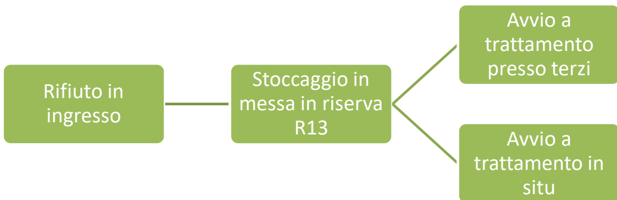
Figura 6 - Schema gestione rifiuti sottoposti alla messa in riserva R13
