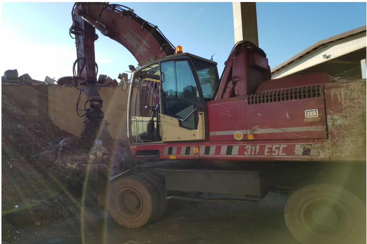
Figura 20 – Fotografia del SOLMEC 311 ESC con agganciato il polipo.
