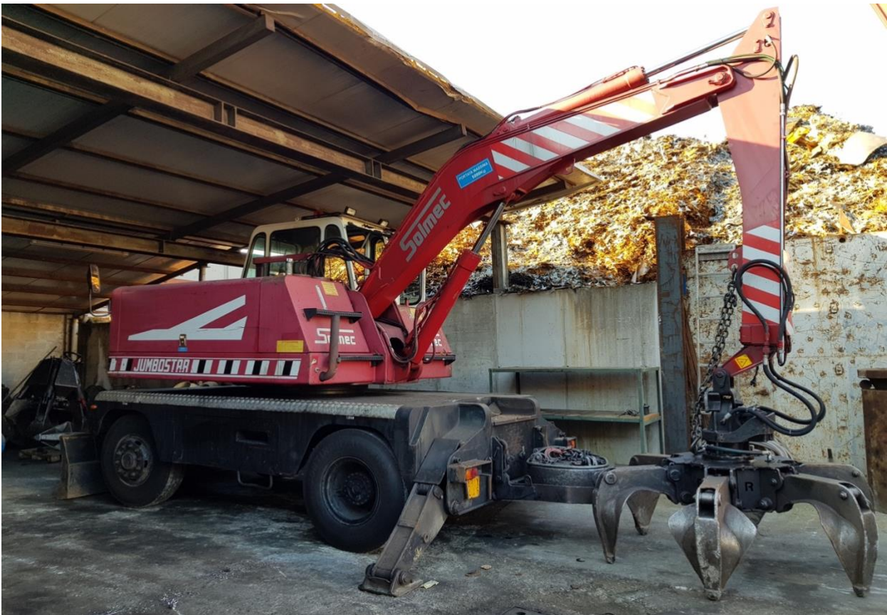
Figura 23 – Fotografia del SOLMEC Jumbostar con agganciato il polipo.
