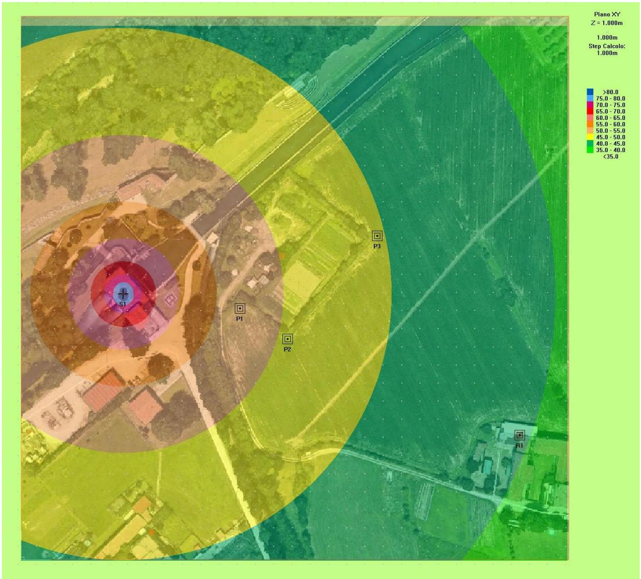
Sulla base del modello numerico si ottiene che nel punto R1 (abitazione più vicina all'edificio di progetto) il livello di rumore generato dalla centrale idroelettrica, principale sorgente dell'area, vale:
