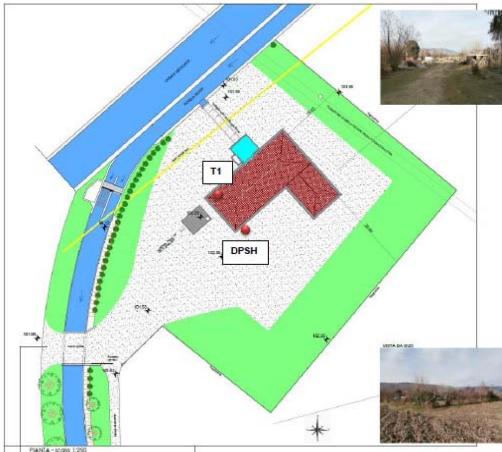
Figura 70 Planimetria con ubicazione delle indagini geologiche.
