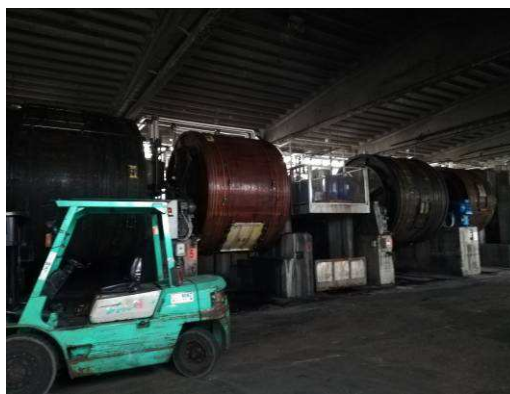
Foto n.3 - 4 : Macchinari per il trasporto della pelle da lavorare e botti di tintura
