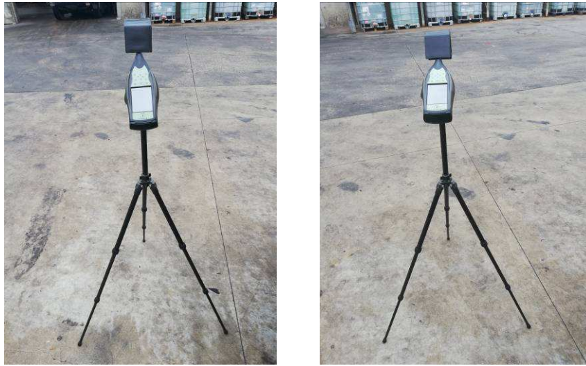
Foto n. 5 e n.6 : fase di calibrazione ad inizio e fine delle misure
