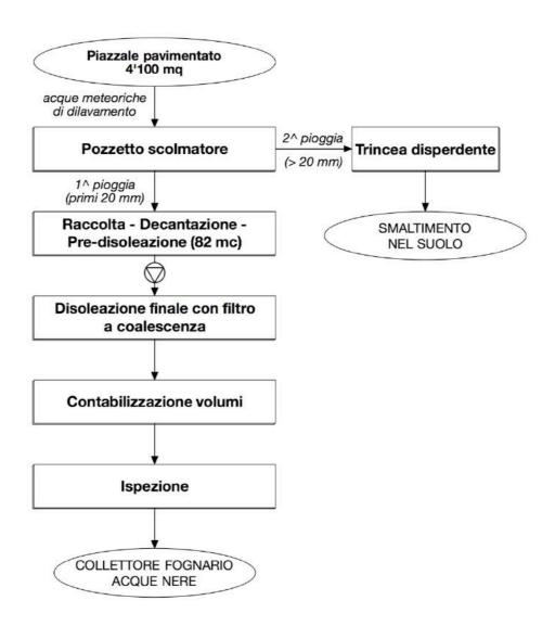
Schema a blocchi del sistema di raccolta e trattamento delle acque meteoriche di "prima pioggia".
