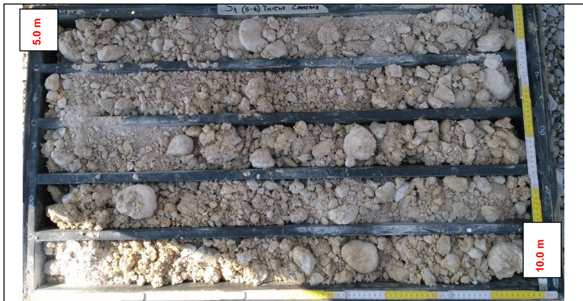
Cassetta catalogatrice di campione prelevato nel sondaggio S1 tra 5 e 10m di profondità.
