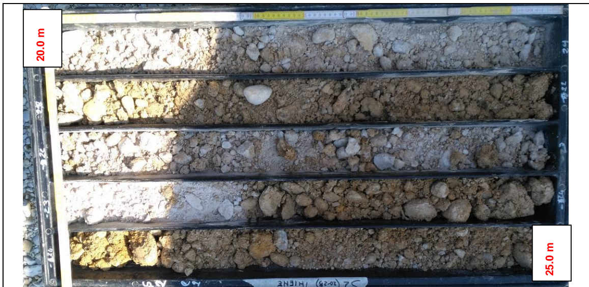
Cassetta catalogatrice di campione prelevato nel sondaggio S2 tra 20 e 25m di profondità.
