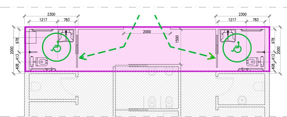
BLOCCO BAGNI MALL - SERVIZI IGIENICI ACCESSIBILI A PERSONE CON RIDOTTA O IMPEDITA CAPACITA' MOTORIA DETTAGLIO A
