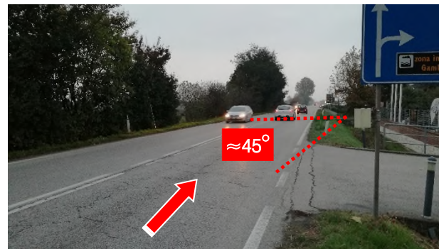
Figura 3 – Angolo di installazione dei radar rispetto alla direzione di marcia
