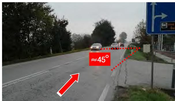
Figura 5.2 – Angolo di installazione dei radar rispetto alla direzione di marcia
