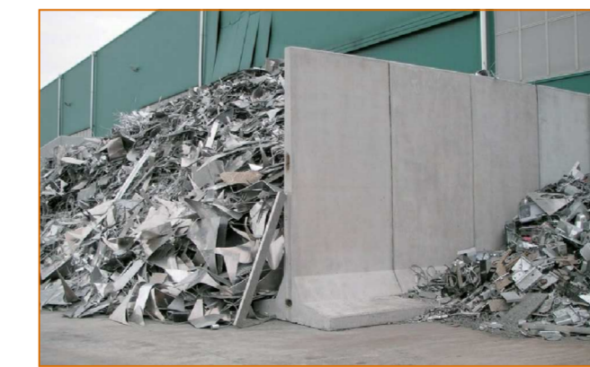
ESEMPIO DI BARRIERA NEW JERSEY (B)
