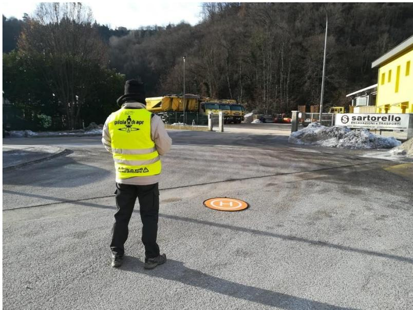
Il rilievo dal punto di vista operativo è suddivisibile in tre differenti fasi, delle quali la prima si basa sull'acquisizione di un dataset di coordinate, relative a punti distinguibili dalla foto aerea (GCP), per la correzione geodetica delle coordinate in fase di post-processamento. Tale attività consente di inserire dei vincoli indispensabili per la risoluzione matematica del principio di collinearità (principio base dello SfM).
