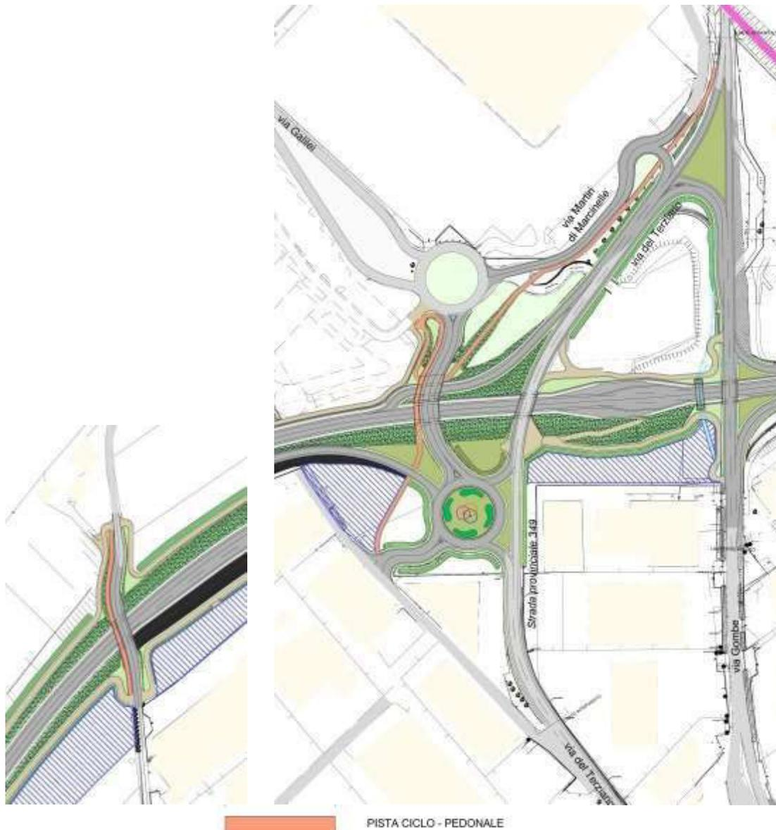
*Estratti dalla Planimetria di Progetto: a sinistra l'interferenza con via Campazzi e a destra via del Terziario. In arancione sono evidenziate le piste ciclabili di progetto.*
