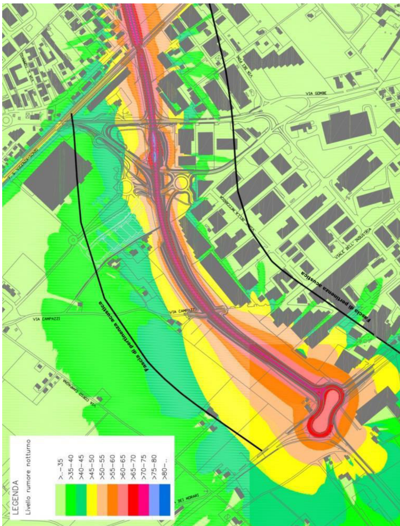
Rappresentazione dell'isolivello sonoro simulato Laeq (dBA) a Q.+4.00 - Stato di progetto senza barriera, periodo di riferimento notturno.
