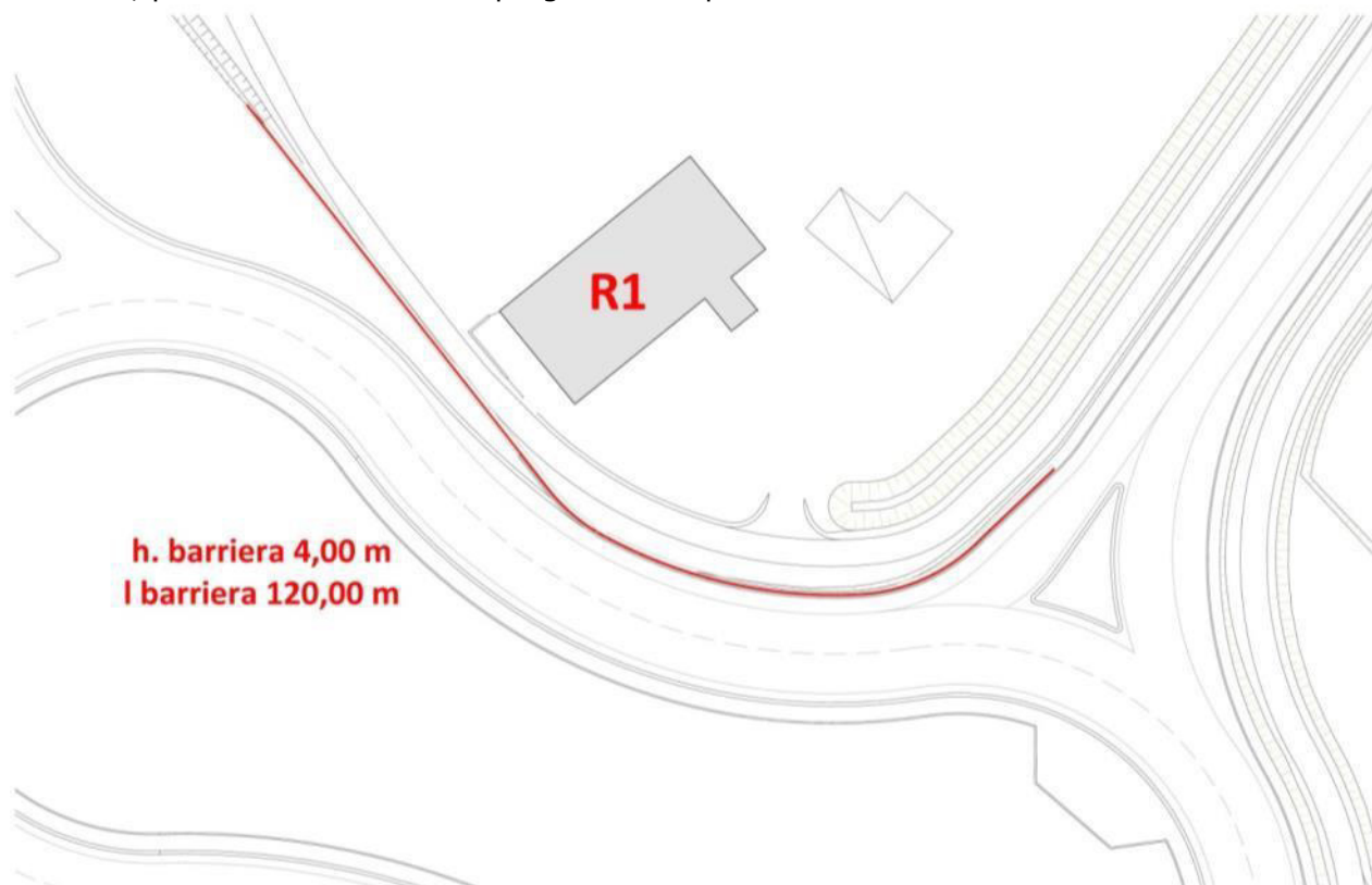
Planimetria del posizionamento della barriera fonoassorbente a protezione del recettore R1.
