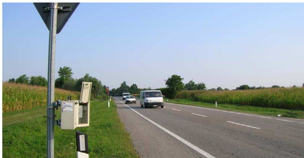
Figura 10: Dispositivi Viacount II – radar dopler – esempio di installazione
