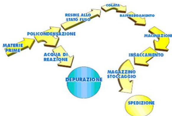
Figura 0.3 – Schema per la produzione di resine in polvere
