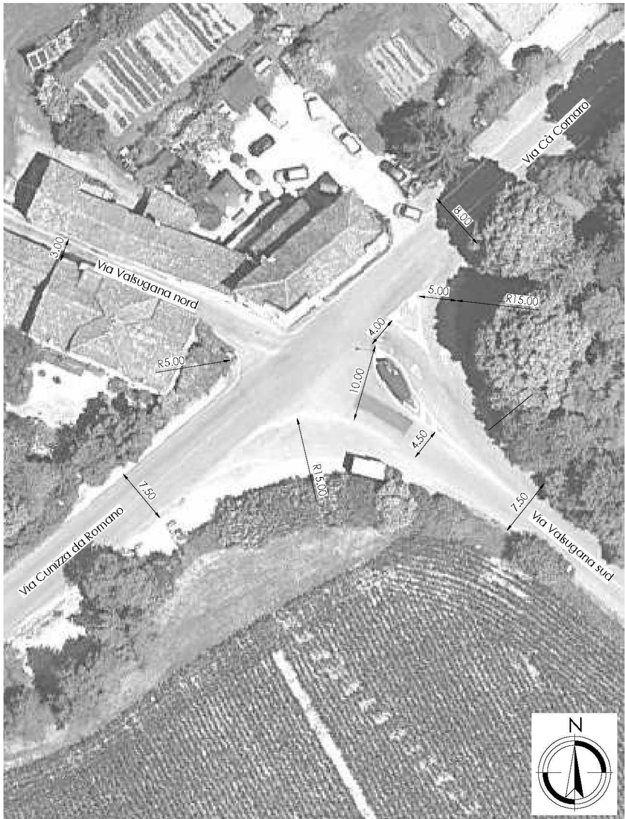
Figura A.6 – Caratteristiche geometriche Intersezione 3
