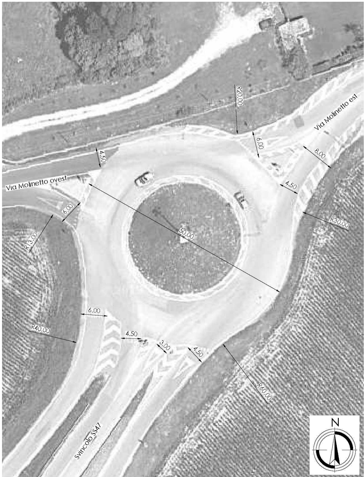
Figura A.4 – Caratteristiche geometriche Intersezione 1
