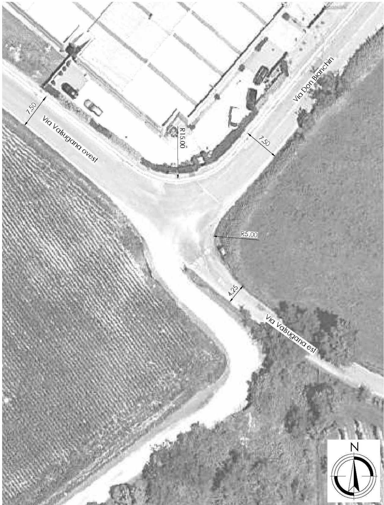
Figura A.7 – Caratteristiche geometriche Intersezione 4
