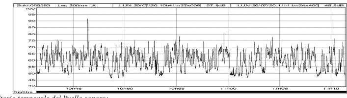
Acu\_11\_20\_climaP7.CMG File Inizio 20/07/20 10:41:27:000 20/07/20 11:11:24:700 Fine Tipo Wgt Unit Leq Lmin Lmax L99 L95 L90 L10 L5 Solo 065583 Leq A dB 65,7 46,0 91,9 47,6 49,1 50,4 68,2 70,0
