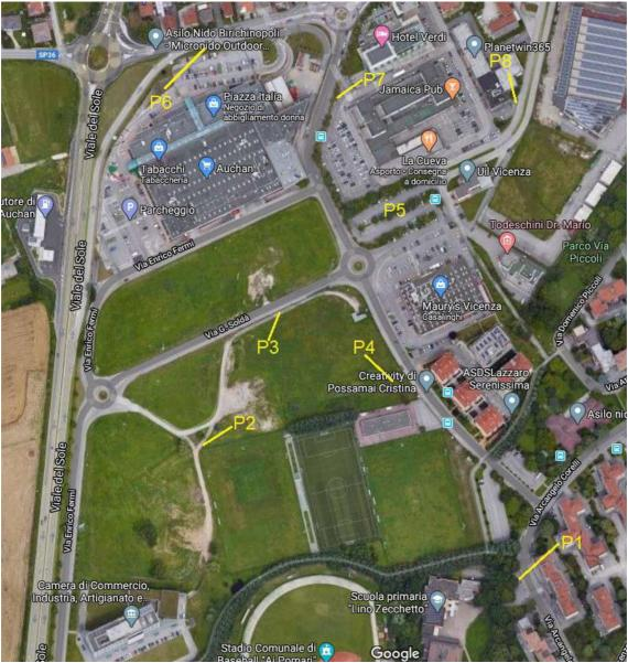
Planimetria delle posizioni fonometriche P: posizione fonometrica
