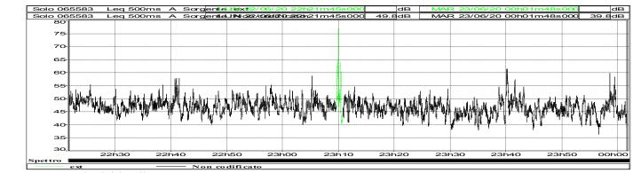
Acu\_11\_20\_clima\_not\_P2.CMG File Solo 065583 Ubicazione Tipo dati Pesatura 22/06/20 22:21:45:000 Inizio 23/06/20 00:01:48:800 Fine Leq Leq Sorgente (parziale) Lmin Lmax L99 L95 L90 L10 L5 dB dB dB dB Sorgente 47,5 33,7 63,2 38,1 41,4 42,7 49,9 50,9 Non codificate 47,6 Globale 48,5 48,5 33,7 78,2 38,1 41,4 42,6 49,9 51,0
