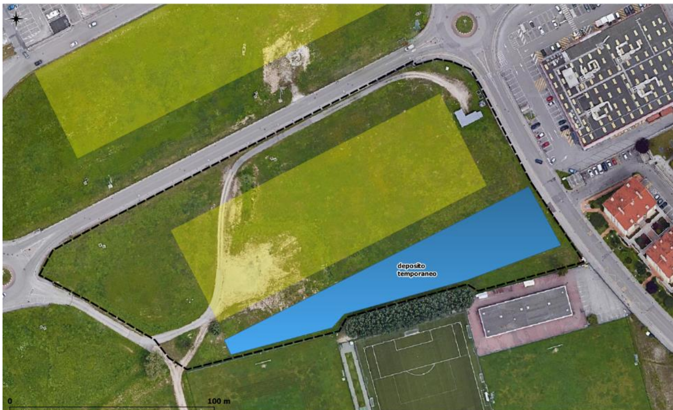
Figura 9: settore destinato al deposito temporaneo delle terre all'interno dell'area di cantiere (tratteggio nero) dell'edificio 3B
