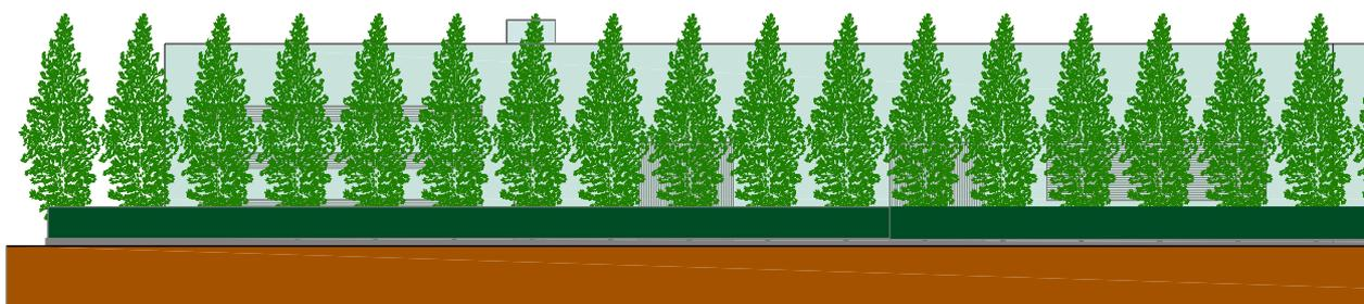
Prospetto lato sud-ovest – schema di mascheratura con siepe arborea costituita da alberi tipici della pianura (le alberature di altezza superiore all'edificio andranno a mascherare lo stabile); sul perimetro esterno sulla recinzione si prevede di applicare un telo oscurante fino all'altezza di 2 metri.
